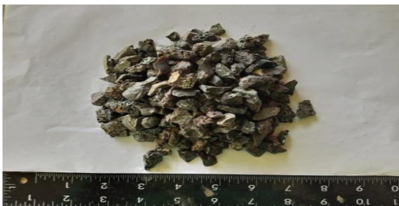
Fig. 2. Samples of steel-slag
