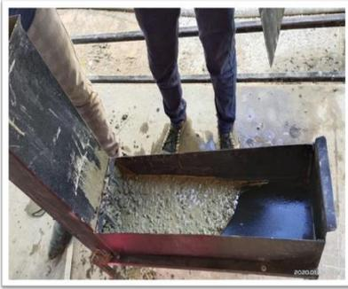
Fig. 5 L box test
