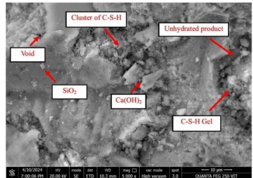
(d) SEM image at 20 kv, 5000 x
