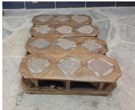
Fig. 8. Mortar cubes in mold
