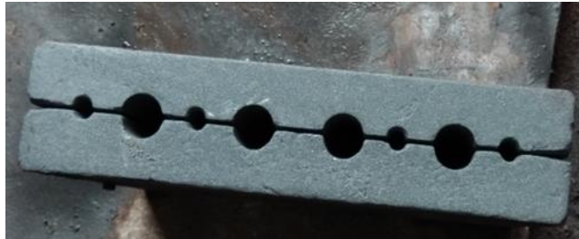
Fig. 4. Cast iron die
