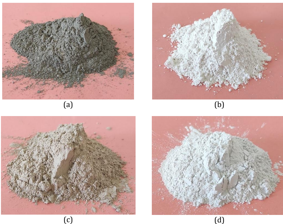
Fig. 3. (a) General aspect of Cement, (b) MP, (c) GGBS and (d) GFRPW
