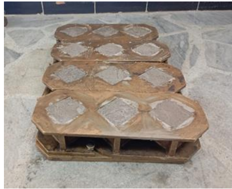
Fig. 8. Mortar cubes in mold
