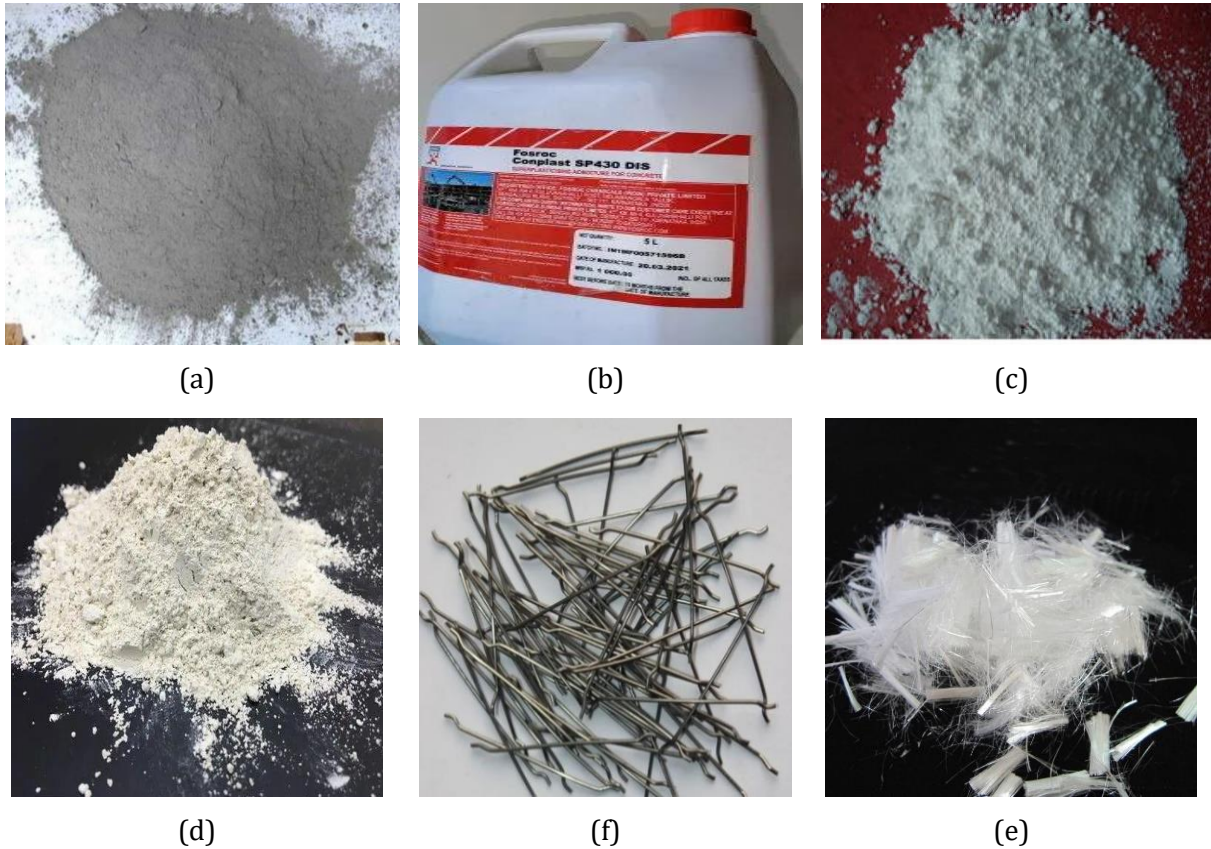
Fig 1. a) OPC, b) Superplasticizer, c) Alccofine, d) Zeolite, e) steel fiber, f) Polypropylene fiber
