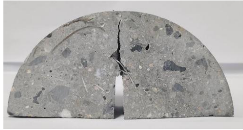
(f) L=35\text{mm} , D=0.55\text{mm} , V_f=0.9\%
