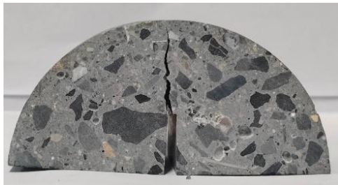
(i) L=25\text{mm} , D=0.80\text{mm} , V_f=0.9\%
