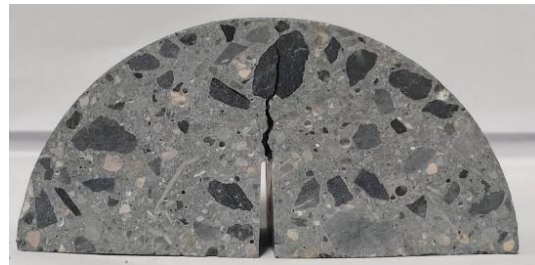
(j) L=30\text{mm} , D=0.80\text{mm} , V_f=0.9\%
