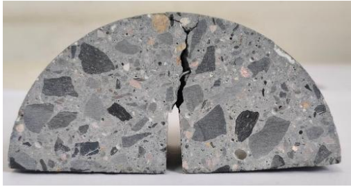
(e) L=30\text{mm} , D=0.70\text{mm} , V_f=1.2\%
